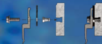
Отверстие и вырезы под крепление скрытой системы вентилируемого фасада
